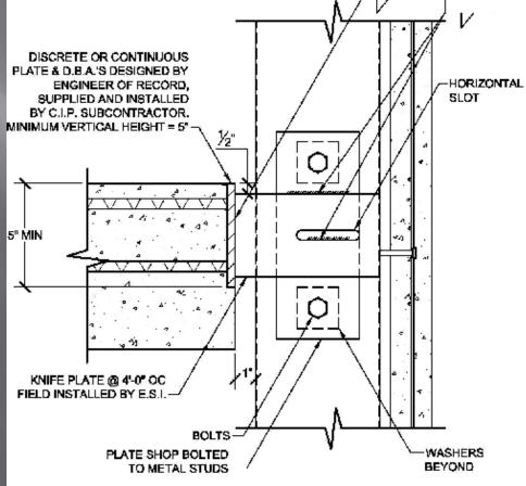
GRAVITY CONNECTION @ CAST-IN-PLACE SLAB
